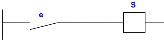
Le contact concrétise, par ses deux positions, les deux états d'une variable binaire d'entrée. Le contact **e** est la variable d'entrée. **S** est la variable de sortie.
